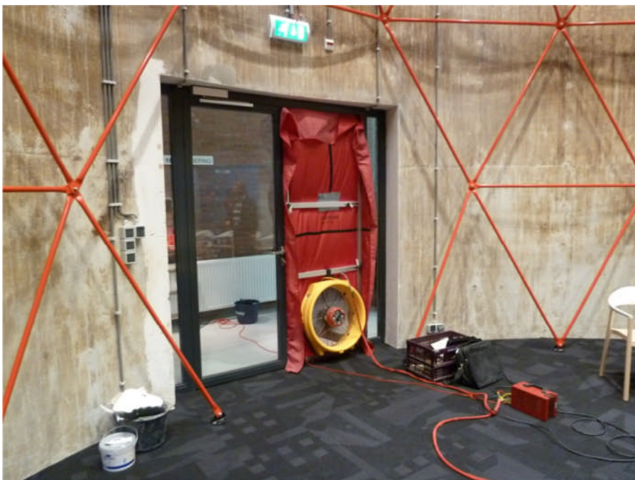
Foto 4.38: 10 e verdieping – opstelling van de Blowerdoor – de ruimte is op een onderdruk van circa 60 Pascal gebracht.
