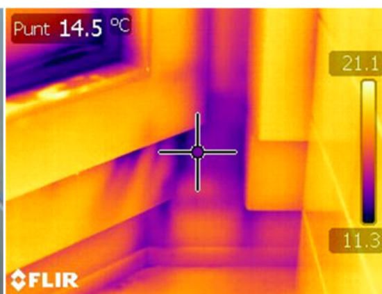
Foto 4.67d: Plaatselijk is de gevel slechts 9,1 °C bij een binnentemperatuur van circa 18 °C.
