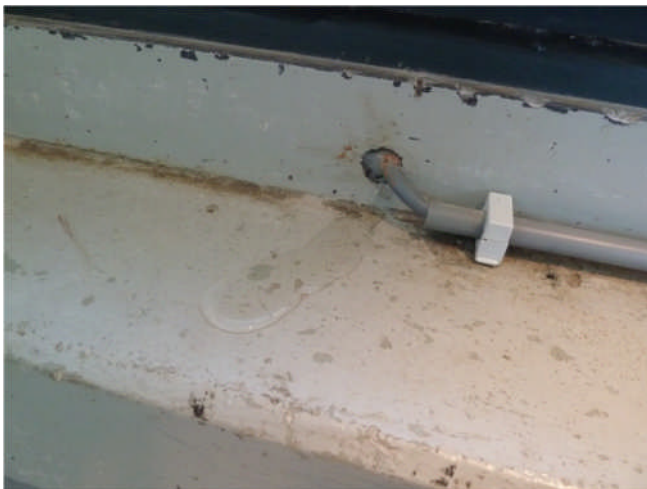
Figuur 4.5: Positie sproeitest 12 e verdieping (lifthal) – lekkages na enkele minuten, zie volgende foto's.
