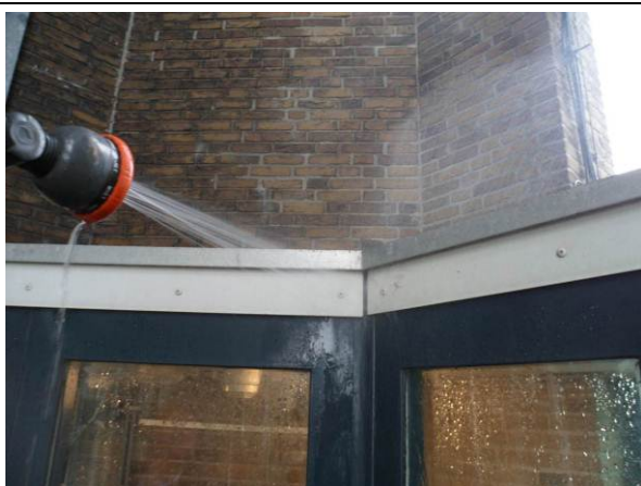
Foto 3.11 en 3.12: naden tussen de beplating bij de bovendorpel, water treedt binnen uit, ook bij de koppelstijlen.
